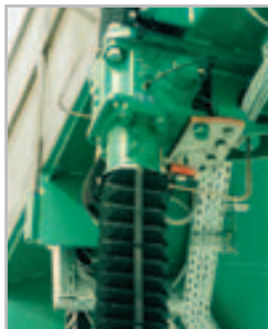
Dispositif de levage volant avec protection par soufflet pour une course de 9 m environ. Photo d'usine MAN Technologie AG
