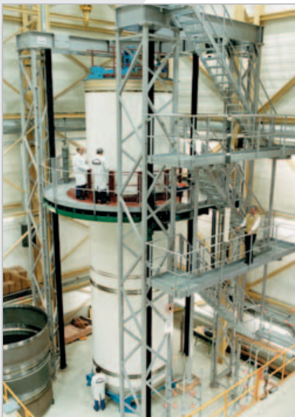
Dispositif de levage volant avec protection par soufflet pour une course de 9 m environ. Photo d'usine MAN Technologie AG
